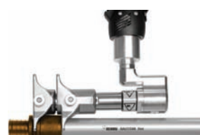
ШАГ 3. Надвинуть гильзу на трубу с помощью инструмента
